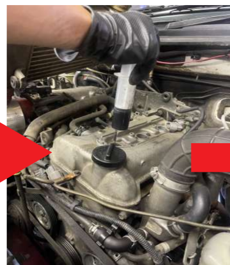
シリンダーから洗浄液を抜く
