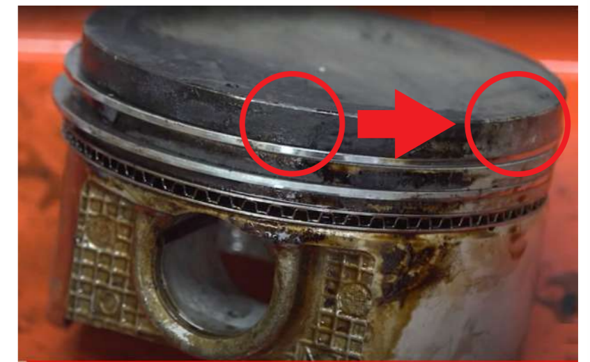
カーボンが溶けて剥がれていきます！
