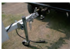
トレーラーの連結部(カブラー)をボールマウントのところに置く。
