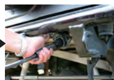
灯火用コネクタを車の電源ソケットに接続する。
