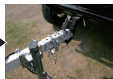
カブラーがマウントに完全にかぶさるまで下げる。
