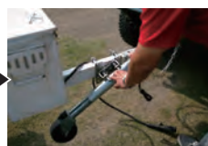
高さを調整するジャッキホイールを上げ、カブラーをロックする。
