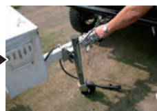
ジャッキホイールのレバーを操作し、カブラーをマウントにかぶせる。
